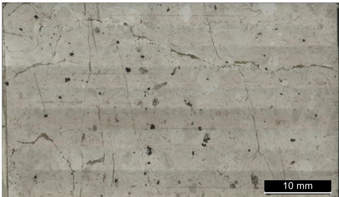
Figura 5.1: Mosaico fotomicrográfico de dacito porfirítico obtido em luz transmitida sob polarizadores paralelos. A matriz é truncada por vênulas de clorita \pm epídoto \pm calcita da alteração propilítica. As manchas arredondadas de cor cinza-claro e marrom representam os porfiroclastos.
